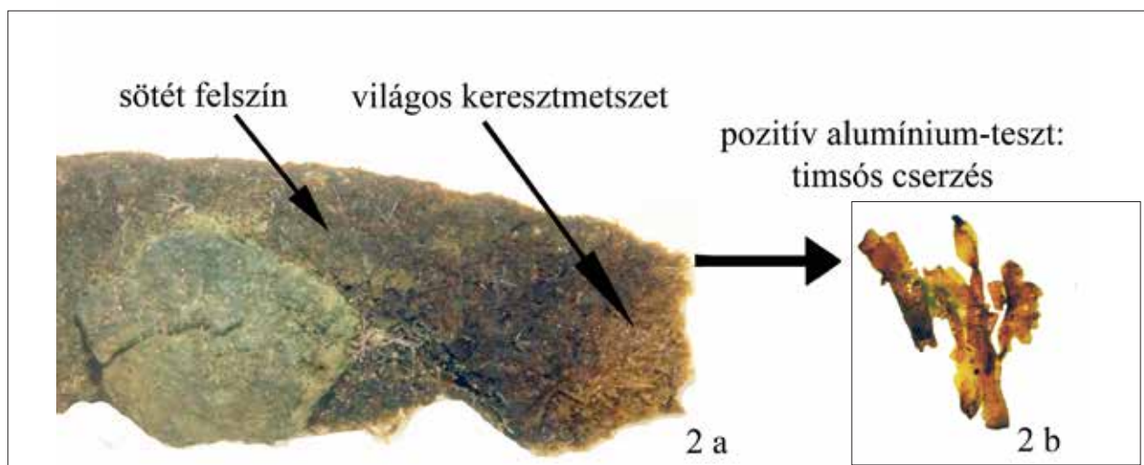
9. ábra. 1a–1c: A bőröv szegélyének varrása és a zsiradékkal bevont szegőfonal technológiai vizsgálatának eredménye; 2a–2b: A bőröv részletének cserzésre vonatkozó kémiai vizsgálatának eredménye
