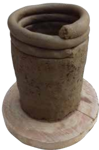
AGYAGHURKÁKBÓL, FELRAKÁSOS TECHNIKÁVAL KÉSZÜLŐ ELŐFORMA. FOTÓ: VÉNINGER PÉTER
