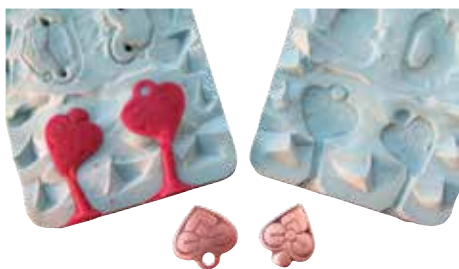
A KÉSZÍTÉSTECHNOLÓGIA FŐBB LÉPÉSEI NEM SOKAT VÁLTOZTAK A HONFOGLALÁS KORA ÓTA, VISZONT A FELHASZNÁLT ANYAGOK IGEN. A KÉPEN EGY VULKANIZÁLT GUMIBÓL KÉSZÜLT NEGATÍV ÉS A BENNE LÉVŐ VIASZPOZITÍV LÁTHATÓ
